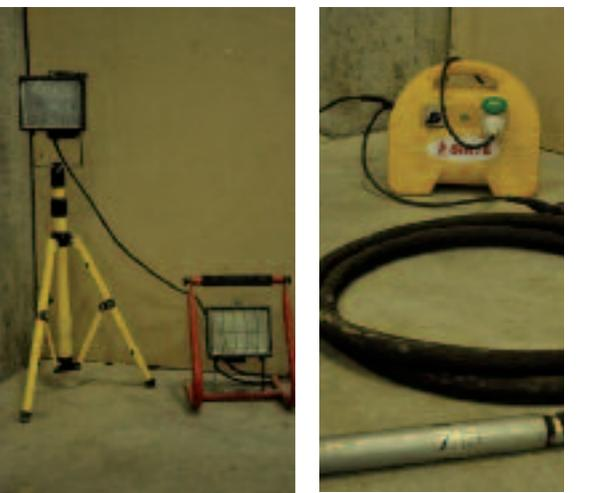
Gli attrezzi a bassissima tensione e le lampade portatili vanno allacciati ad un apposito trasformatore portatile.
