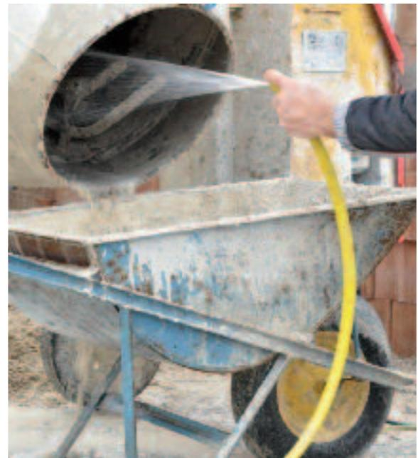
Lava la betoniera a bicchiere con abbondante getto d'acqua, togliendo tutte le incrostazioni. Se nel bicchiere restano grumi di malta, versa della ghiaia e fallo girare a lungo. Raschia poi con la cazzuola a betoniera spenta.
