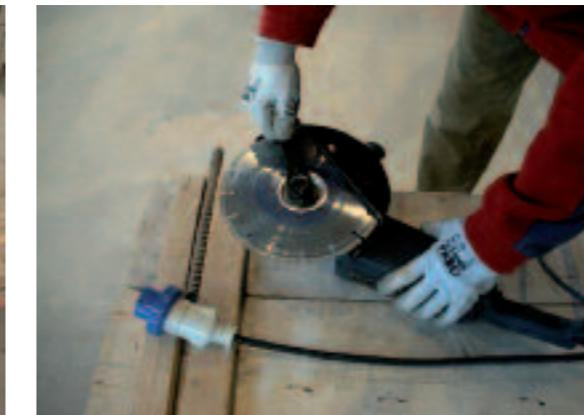
Prima di cambiare il disco del flessibile stacca il cavo dell'alimentazione e aspetta che sia completamente fermo. Se lo posi a terra o lo passi ad un collega, aspetta sempre che il disco sia completamente fermo. Nelle pause di lavoro e alla fine stacca sempre il cavo dalla presa elettrica; non lasciare l'attrezzo incustodito in tensione.
