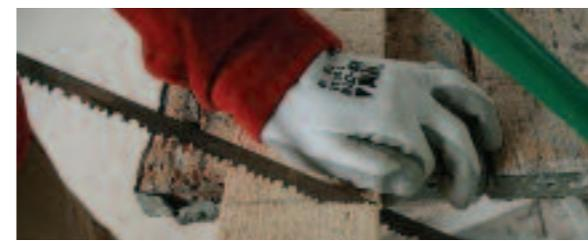
Inizia a segare in modo da formare la sede (un solco) lungo la linea di taglio, imprimendo una pressione adeguata (ma senza forzare). I denti della lama devono "saltare" scorrere sul taglio.
