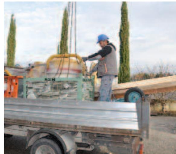
Comincia a caricare sempre dal retro cabina: carichi singoli (es. una betoniera o una sega circolare) vanno saldamente legati, per esempio alla sponda fissa dietro la cabina. Se si tratta di un pezzo pesante sistemalo a metà degli assi.
