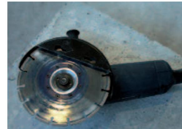
Prima di utilizzare la mola portatile, controlla che sia presente la protezione metallica sull'impugnatura. Verifica che l'indicazione del numero di giri per minuto (RPM) presente sull'utensile non sia superiore a quella indicata sul disco. Verifica che il disco sia adeguato rispetto all'elemento da tagliare.
