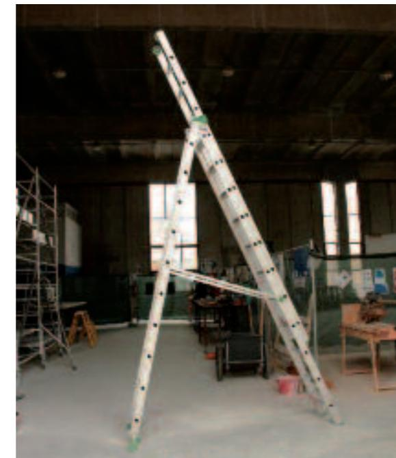
Se usi una scala a libro aprila fino a tendere la catena tra i montanti oppure blocca il dispositivo che impedisce alla scala di aprirsi oltre i limiti di sicurezza.
